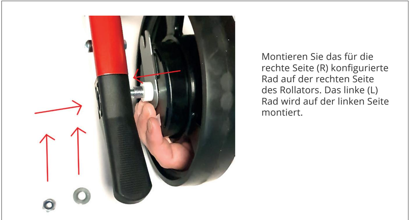
Montieren Sie das für die rechte Seite (R) konfigurierte Rad auf der rechten Seite des Rollators. Das linke (L) Rad wird auf der linken Seite montiert.
