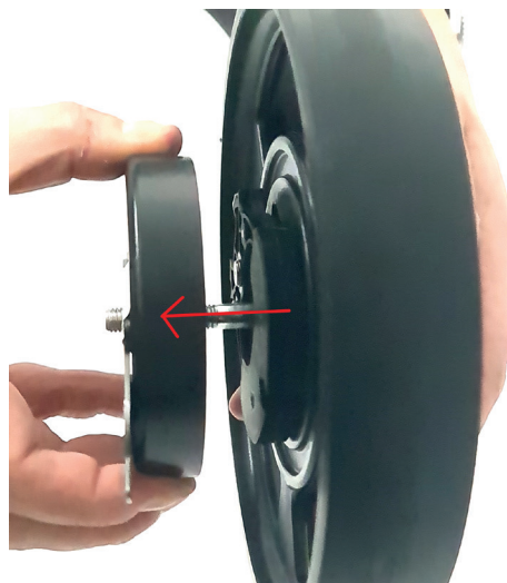
Bild: Demontage der Bremstrommel
