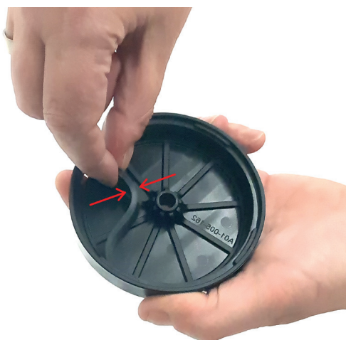
Bild: Ausbauen des Bremsbelags
