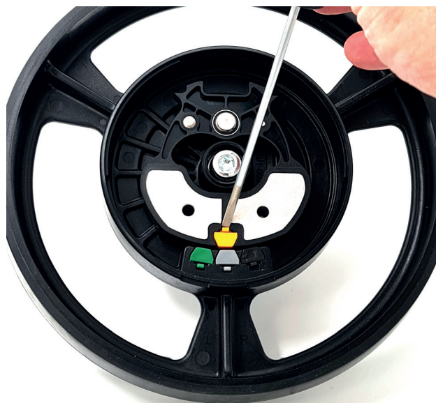
Bild: Entfernen Sie den Aktivierungssicherungsstecker vorsichtig mit einem kleinen Schraubenzieher.
